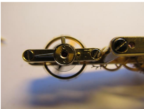
De complete balans in het uurwerk geplaatst, het bleek dat de balans onvoldoende hoogtelucht had . Er is getracht dit met vulringetjes op te lossen. Dit gaf niet voldoende ruimte. Kloofje losgenomen van de balans en gecontroleerd. Hierbij bleek dat het kloofje iets doorgebogen was, dit verklaarde de beschadigingen. Door het doorbuigen was getracht de balans met afgebroken astap toch te laten functioneren.
