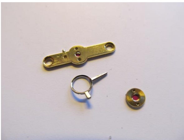
Het kloofje met de losse onderdelen van het kompas. Duidelijk zijn de beschadigingen te zien.
